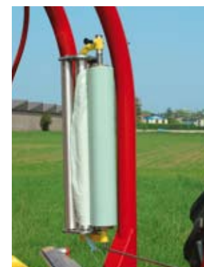
Particolare del gruppo stirafilm. Detail of the film stretcher device. Detail vom Filmspanneinrichtung.
