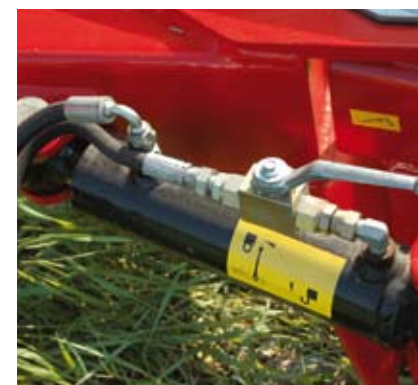
Cilindro apertura chiusura idraulico. Opening and closing hydraulic cylinder. Hydraulischer Zylinder Öffnung und Schliessung.
