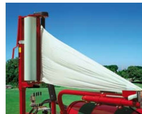
Gruppo stirafilm regolabile. Adjustable film stretcher unit. Einstellbare Filmspanneinrichtung.
