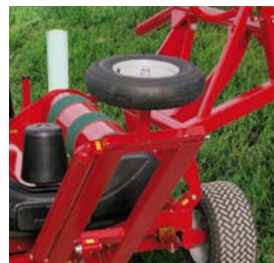
Ribalatore posteriore (verticale). Rear vertical bale rotator. Hintere senkrechte Ballenentladerampe.
