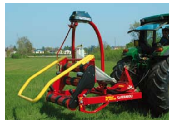
Fasciatore posteriore con pattini d'appoggio (ruote opzionali). Rear wrapper with support slides (wheels on request). Hinterer Ballenwickler mit Supportgleiten (Räder auf Wunsch).
